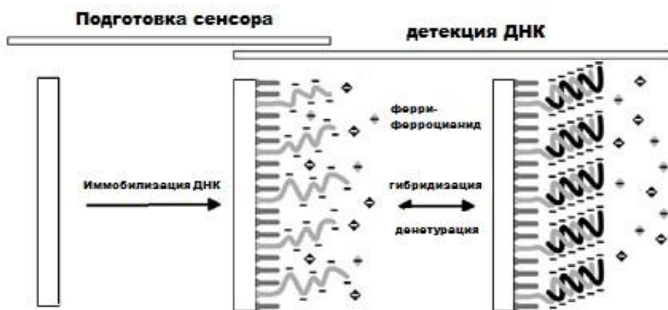
Рис. 5. Схема работы ДНК-биосенсора с использованием электрохимических меток (Тарасов и др., 2014). В качестве меток используется редокс-пара ферри/ферроцианид.
